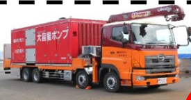
大容量ポンプ (3台/3・4号機)
