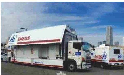
【移動式水素ステーション】
