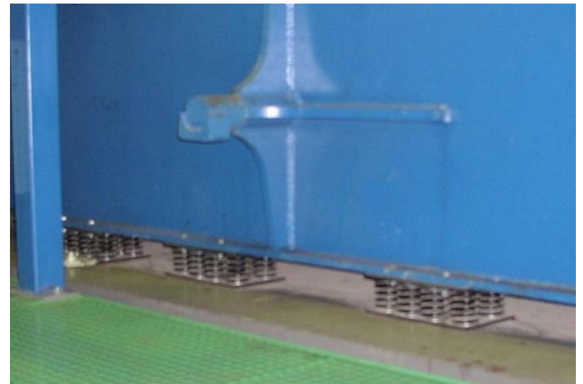
エンジン防振バネ(振動を低減)
