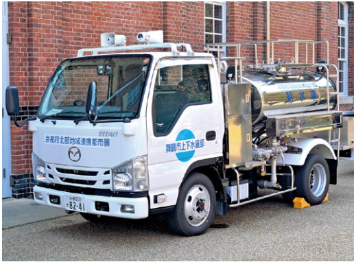
▲供用を開始した加圧式給水車
