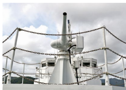
▲放水銃を備え、消火のほか、退去の警告を無視した違法操業船などに放水することも
