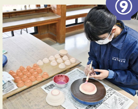
約800度で素焼きする。その後、置くときに接地する面には水剤を塗る。
