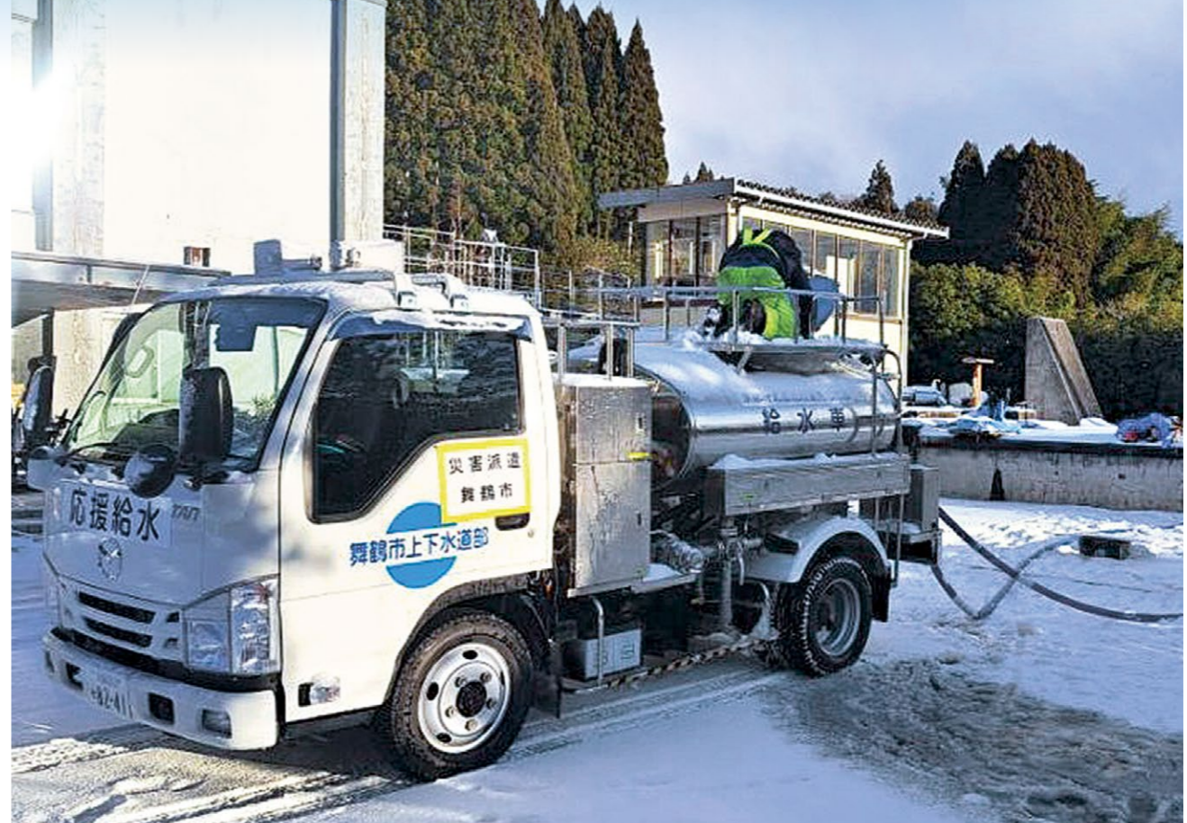
▲能登町の浄水場で水をくみ上げる本市の加圧式給水車
