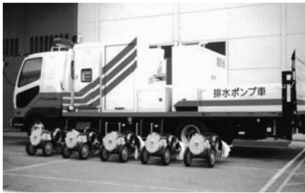
30立方メートル毎分の排水能力を持つ排水ポンプ車
